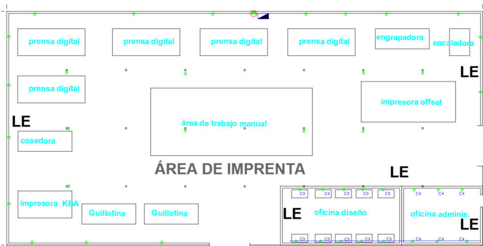
E.1.4. Imagen del sistema eléctrico no estabilizado de las luces de emergencia en el área de imprenta
