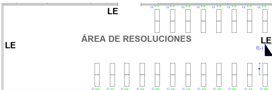
E.1.3. Imagen del sistema eléctrico no estabilizado de las luces de emergencia en el área de resoluciones
